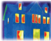
〈단열재 설치 후〉
